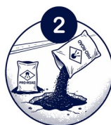
2. DESPEJE E NIVELE
